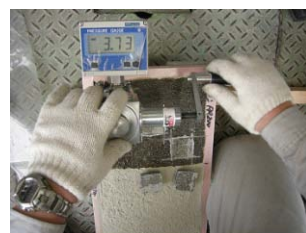
写真-3 補修材と防水プライマーとの付着性確認試験
