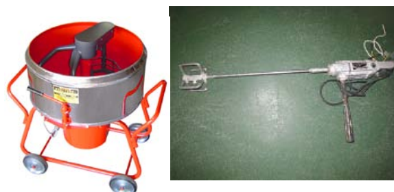
(1) パン型モルタルミキサー (2) 籠型ハンドミキサー 写真-2 製造装置
