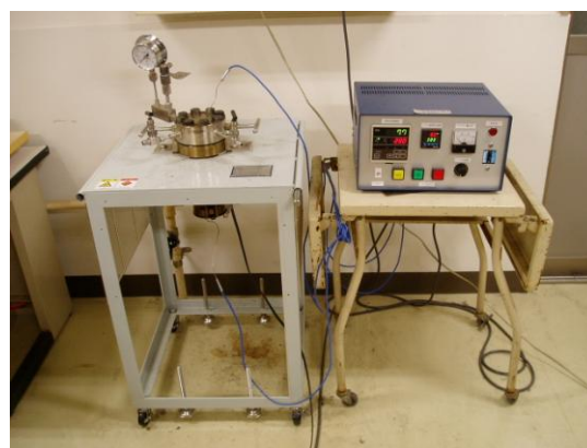
写真-1 高温・高圧処理装置
