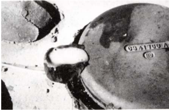
写真4 珪素鉄の鑄物による陽極
