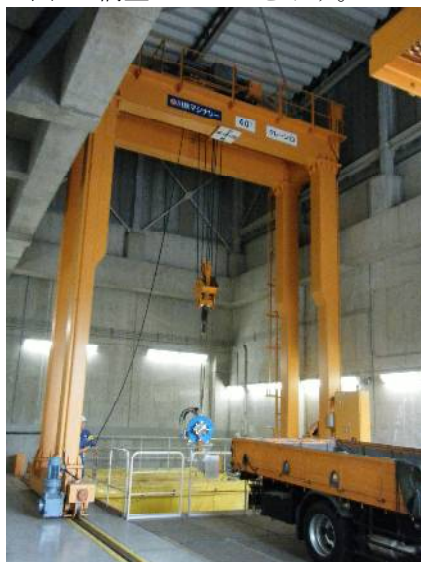
図5 自立自走式中央搬入口 橋型クレーン
