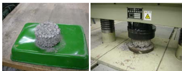
写真-2 圧縮試験(造粒)
