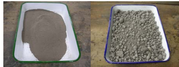
(a) 主灰 (b) 造粒 写真-1 製造された焼却灰焼成物
