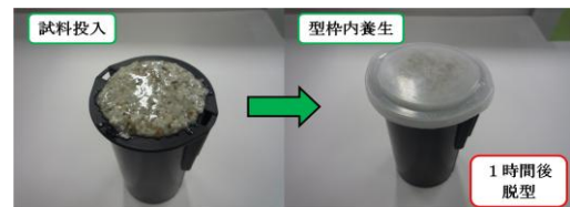
写真-2 軽量型枠内養生
