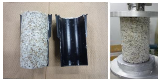
写真-3 脱型後および試験中の供試体
