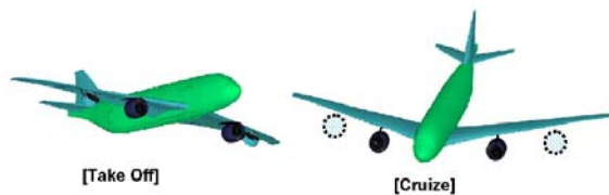
図5 外周駆動電動ファンの適用例
