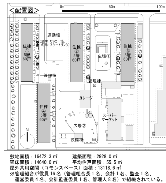
図1 調査対象集合住宅 [BAYANGOL 区 TUMUR ZAM (第2号) 地区]
