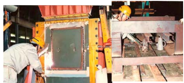
写真-1 試験体の修復状況
