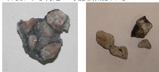
Fig.3 処理後:アルカリ骨材(左)普通骨材(右)
