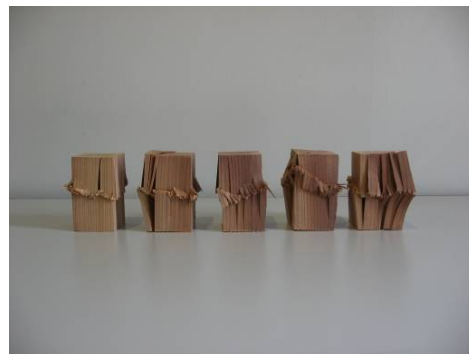
写真5 同寸法による杉の破壊状況
