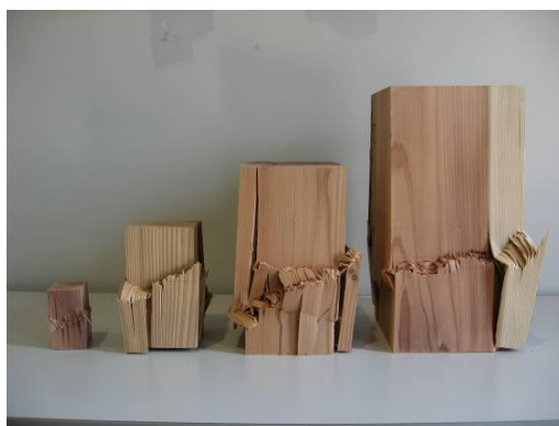
写真3 異なる寸法による杉の破壊状況
