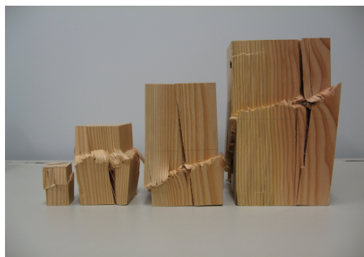
写真2 異なる寸法による米松の破壊状況
