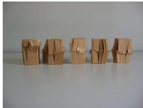
写真4 同寸法による米松の破壊状況
