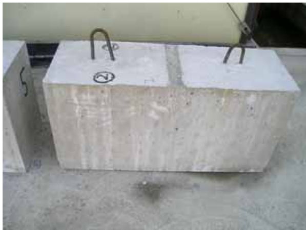
写真4 コンクリート表面の仕上がり状況 (木粉混入率 10%)
