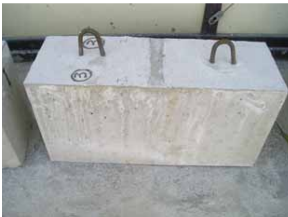
写真5 コンクリート表面の仕上がり状況 (木粉混入率 30%)
