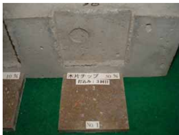
写真3 耐久性試験後の表面状態（木粉30%）
