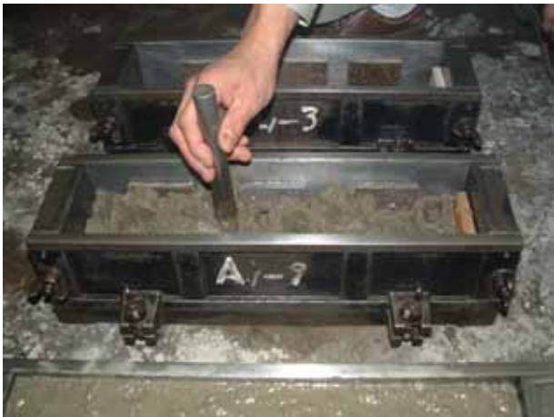
写真2 モルタルの打設状況（繰り返し耐久性試験）
