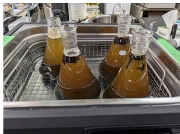
試料乾燥後，ヨウ化ナトリウム水溶液に浸透させ，超音波をかけながら攪拌する。
