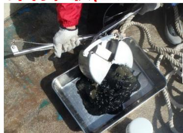
港研式グラブ採泥器を用いて海底土表面から10cm程度を3回採取する
