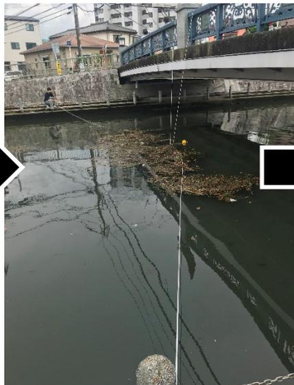
ネットを固定し水質中のMPsを回収
