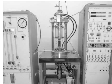
振動三軸圧縮試験機
