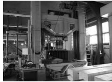
5000kN 構造物試験機（11 号館）
