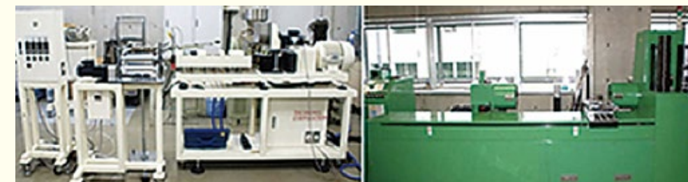
次世代複合材 RG 写真（押出成形機 フィラメントワインディング装置）
