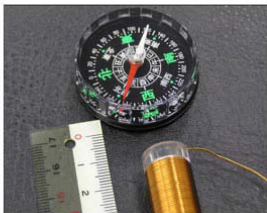
写真:コイルに電流を流すと磁界が発生する。
