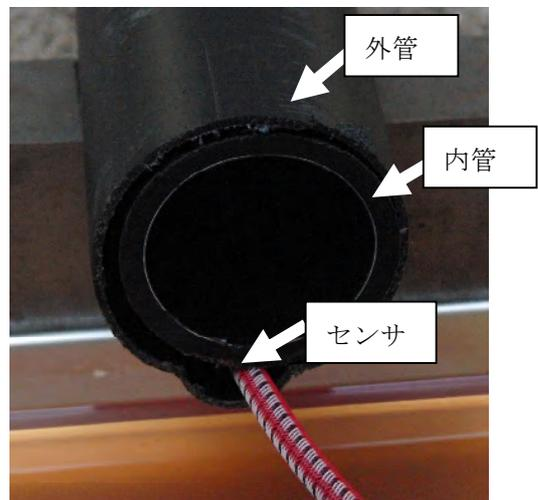
図2 漏洩センサ内蔵の配管
