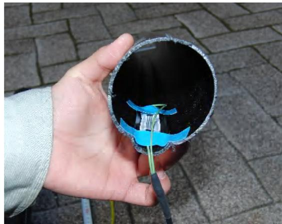
図 1 6 センサの外管への装着状態
