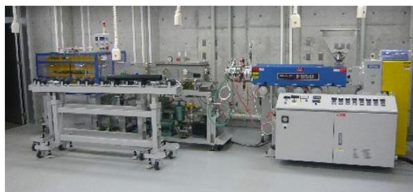
図13 二重管の外管を成形した押し出し機
