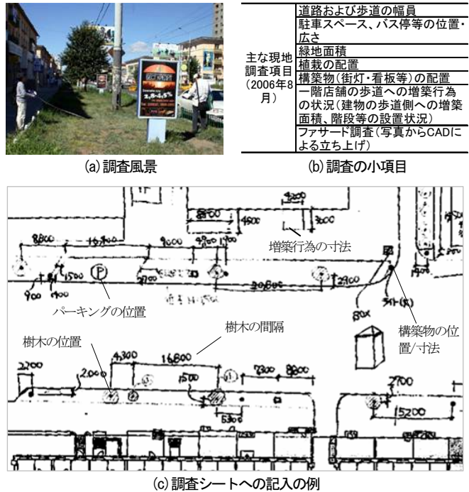
図5 対象地区における現地調査の結果(調査風景、項目、調査シート)
