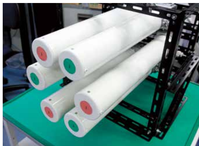
図3 2.5GHz帯の2ビーム空間重畳合成用 フェーズドアレイアンテナの実現例
