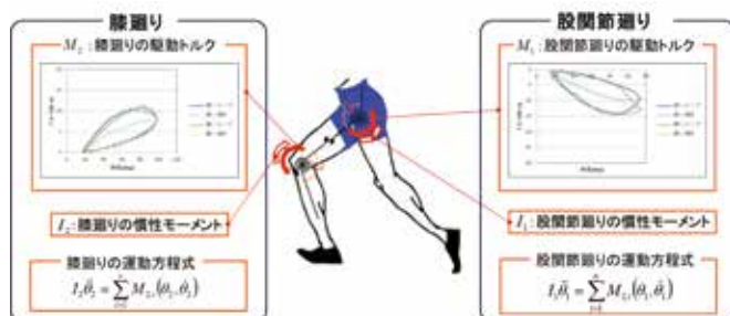
図 関節廻りの筋骨格数理モデルと解析手法
